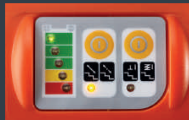
Affichage du niveau de la batterie, fonctionnement marche par marche et ComfortStep
